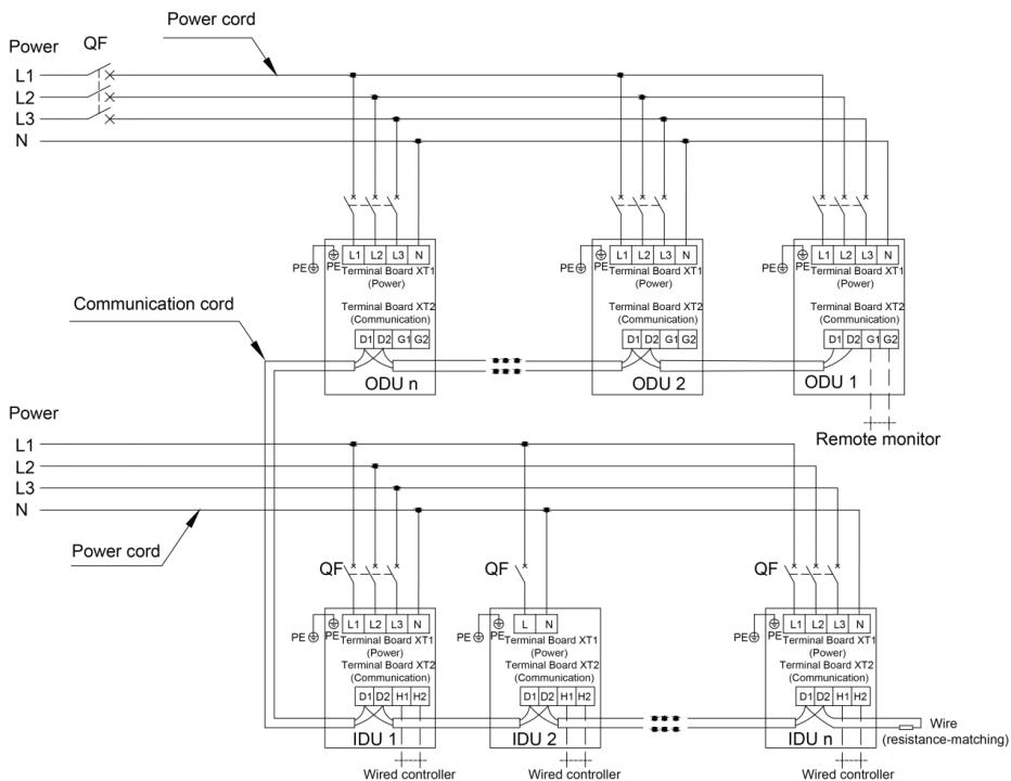
**Электрическая схема подключения для немодульных наружных блоков (SMZUi271V3AI, SMZUi311V3AI) can't operate normally.**
